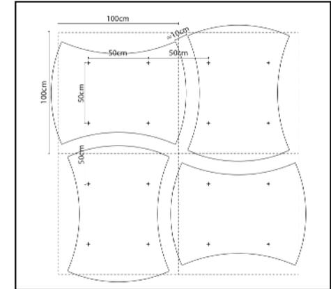
**2.** Entscheiden Sie, wo die Deckeninseln hängen sollen. Zeichnen Sie die Befestigungspunkte an der Decke an.
