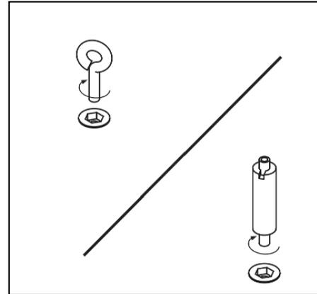
**1.** Schrauben Sie die Schraubösen oder Verbinder in die Deckeninsel.
