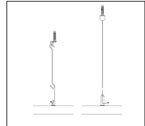
**4.** Hängen Sie die starren Aufhänger in die Schraubösen ein ODER schieben Sie das Drahtseil durch den Verbinder und ziehen Sie es auf den gewünschten Abstand. Durch Drücken des federbelasteten Teils kann das Drahtseil zurückgezogen werden.
