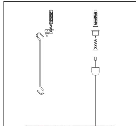
**3.** Bohren Sie an den markierten Stellen Löcher in die Decke und setzen Sie die Dübel ein. Schrauben Sie die D-Ringe an und hängen Sie die starren Aufhänger daran auf ODER schrauben Sie den oberen Teil der Deckenhalterung an und drehen Sie den unteren Teil mit dem durchgezogenen Stahlseil darauf.
