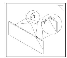
Raccourcissez l'entretoise en carton à la taille souhaitée et placez-la sur le coin d'un déflecteur. Pressez le clip EASYfelt Baffle sur le déflecteur. Répétez l'opération de l'autre côté du déflecteur. Le clip du déflecteur s'enlève facilement en pressant le déflecteur en place.
